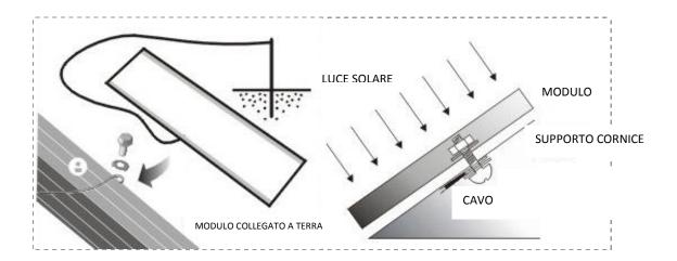
Montare il capocorda di messa a terra al telaio di alluminio utilizzando viti M3, M4 o M5 e componenti di acciaio Inox come mostrato nella figura seguente.
