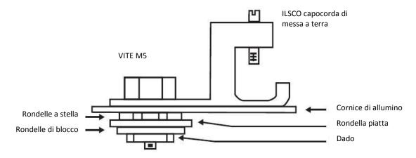
Per moduli con fori di messa a terra con diametro 5.1mm
