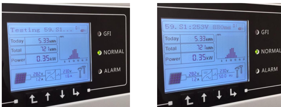
Figura 5 - Fase di testing e visualizzazione della soglia impostata 59.S1
